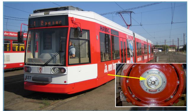
Abb. 1: Diese elektrische Straßenbahn in Halle (Saale), Deutschland, wies Lagerschäden durch umrichterinduzierte Spannungen auf. Das Problem wurde 2007 durch Einbau von AEGIS® SGR Lagerschutzringen (kleines Bild) an den Wellen aller Antriebsmotoren in der Flotte gelöst. Die Stadt betreibt seit 1891 ein Straßenbahnnetz.
